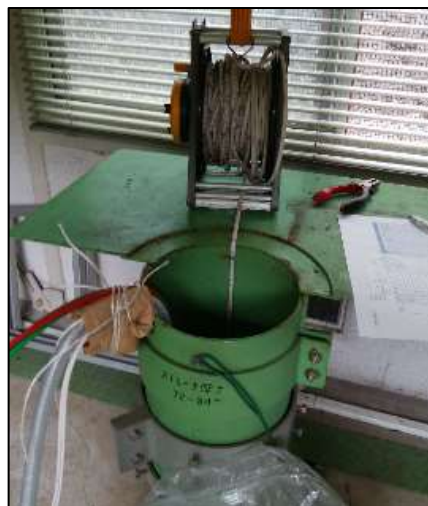
採水前後での井戸水位確認状況
