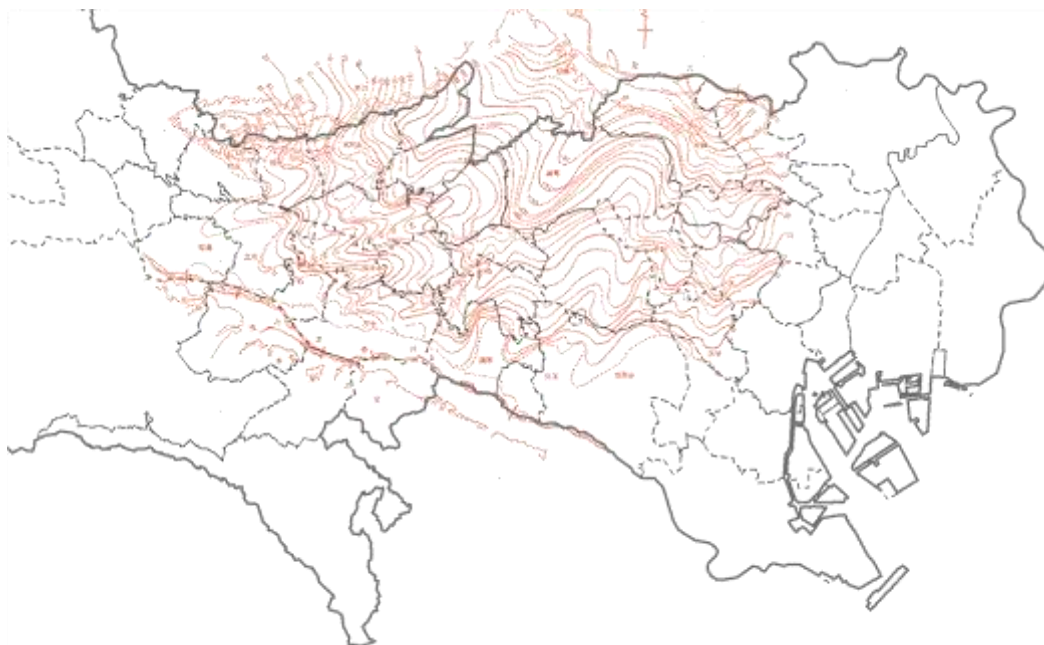
図 5-7 被圧地下水を育む地層の傾き
