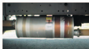
ディーゼル車に装着されたPM減少装置
