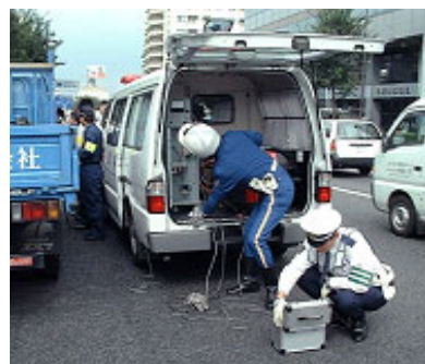
軽油の抜き取り・黒煙検査風景
