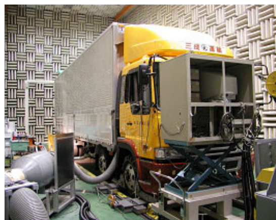
大型自動車を用いた排ガス実験（東京都環境科学研究所）
