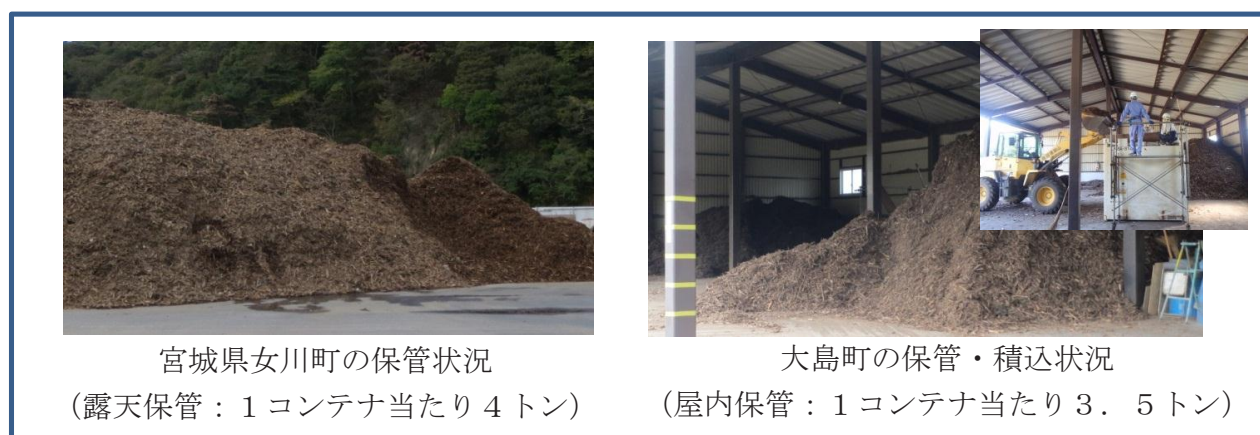
図3-6 可燃性廃棄物の保管状況（宮城県女川町、大島町）
