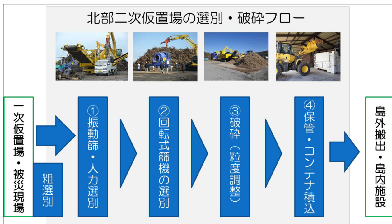
図3-5 北部二次仮置場の選別・破碎工程
