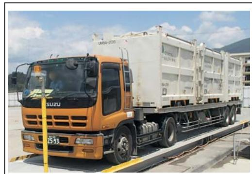
図 4-11 3 基積み集荷車両
