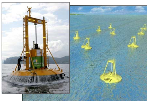
図12 OPT社の波力発電装置パワーブイ
