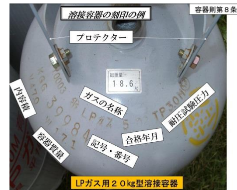
高圧ガス保安法対象容器の刻印、塗装 （（一社）兵庫県LPガス協会HPより）
