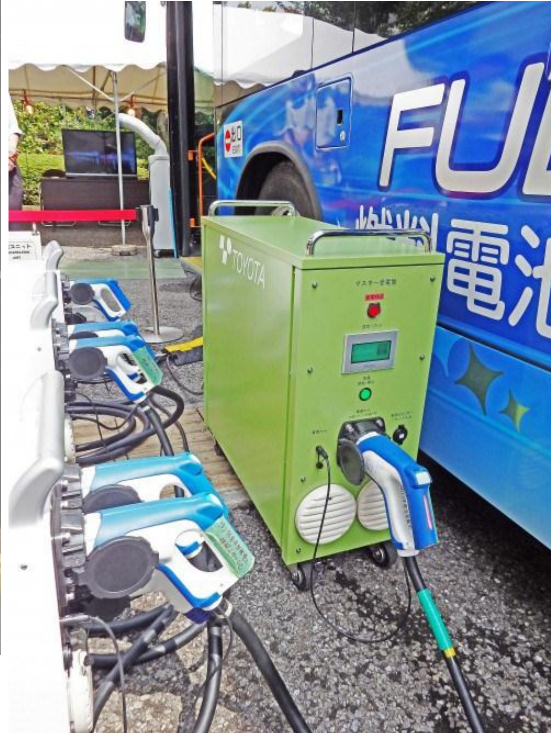
「外部電源供給システム」を使った電力供給のイメージ図 Image of electricity supply using V2H system
