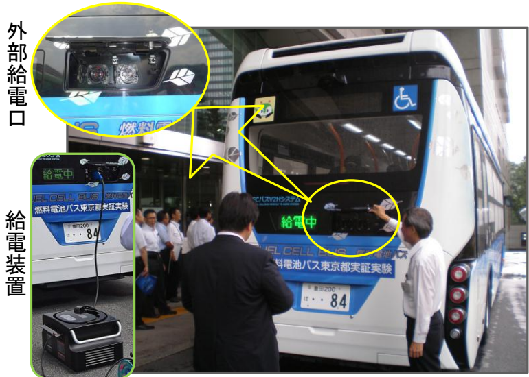
外部給電口と給電装置
