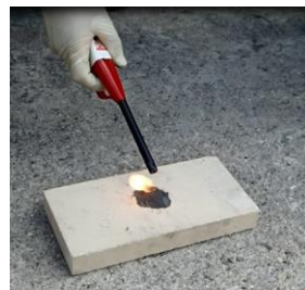
危険物判定のための 着火試験の様子
