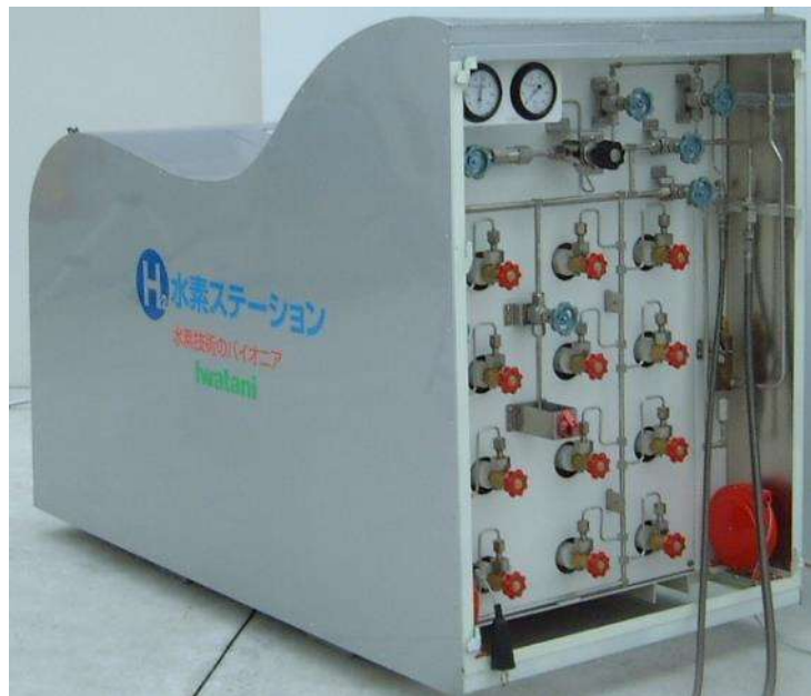
小型移動式ステーション ～40MPa蓄圧器による充填～
