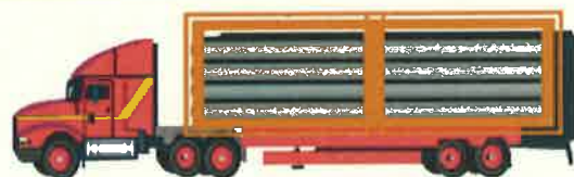
水素トレーラー
