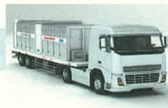
水素トレーラー
