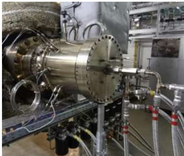
水素専焼ドライ低NOx燃焼器試験 (アーヘン工科大学)
