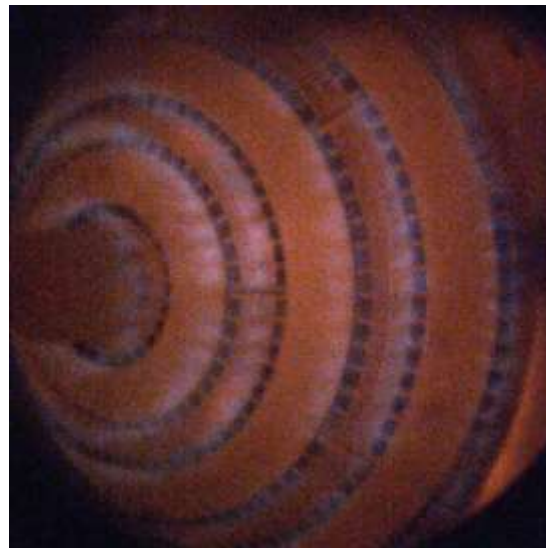
定格条件相当での水素燃焼状態
