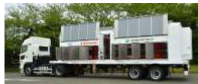
高圧水素トレーラー
