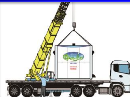
3. トラックから荷下ろし
