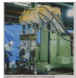
←鉄粉供給機 鉄粉を乾式で供給する装置 高圧空気鉄粉を輸送
