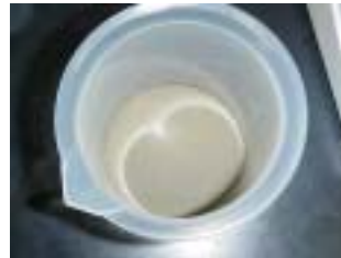
500mlPP ビーカーに土壤試料溶出用 25g を取り，水 250ml を添加 500mlPP ビーカーに土壤試料含有用 4.5g を取り，1M 塩酸 150ml を添加
