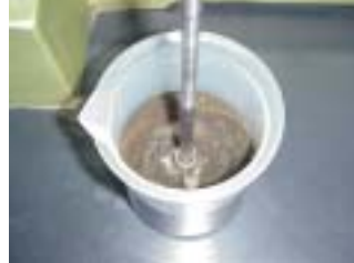
溶出用は 300rpm で 30 分攪拌 含有用は 300rpm で 10 分攪拌
