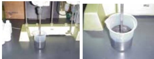
溶出用は 300rpm で 30 分攪拌 含有用は 300rpm で 10 分攪拌
