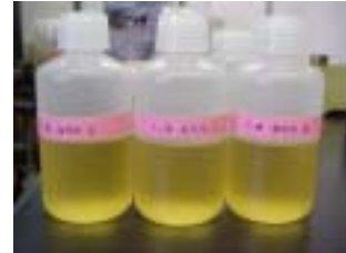
0.45 μm フィルタで吸引ろ過 吸引ろ過液（溶出用） 吸引ろ過液（含有用）
