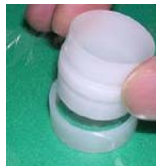
図5. 試料保持フィルムを被せたリングとセル
