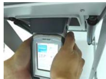
図7. 分析装置をテストスタンドに装着
