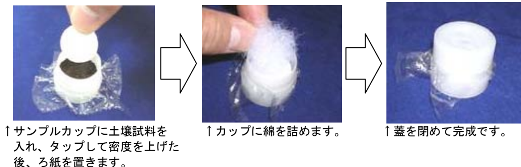
図6. 土壌試料の充填
