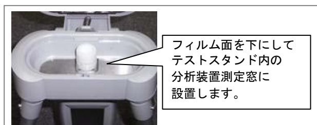
図 9. テストスタンドを使用する場合のサンプルカップの向き
