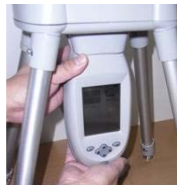
図7. 分析装置をテストスタンドに装着
