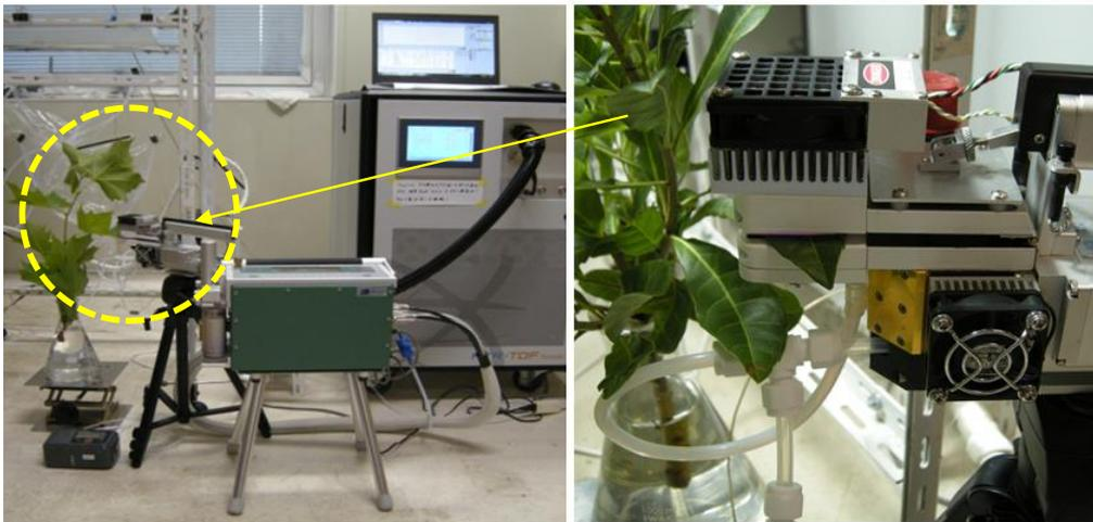
図 2 リーフキュベット法による BVOC 放出量測定
