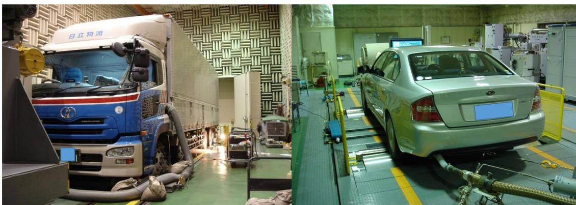
図 18 シャシダイナモメータによる排出ガス測定 (左 : 大型、右 : 小型)
