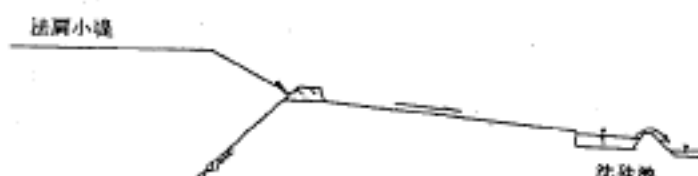
法肩小堤・沈砂池
