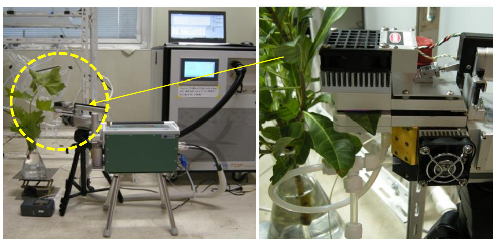
図 2-2 リーフキュベット法による BVOC 放出量測定
